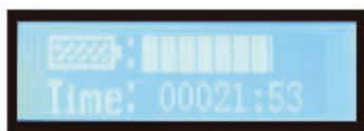
Indicador Digital de Carga da Bateria e Tempo de Uso do Equipamento
